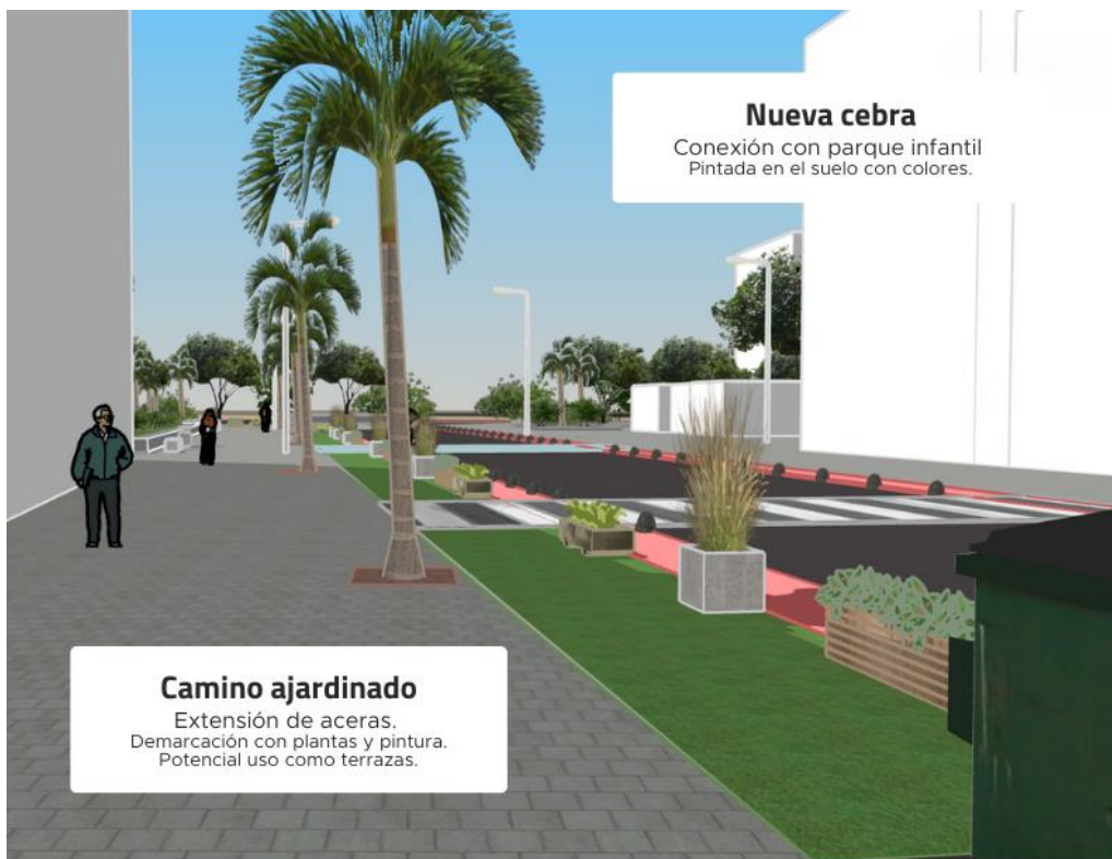
Ilustración 14. Camino ajardinado, carril bici, y conexión con los alrededores. Extensión de aceras.
