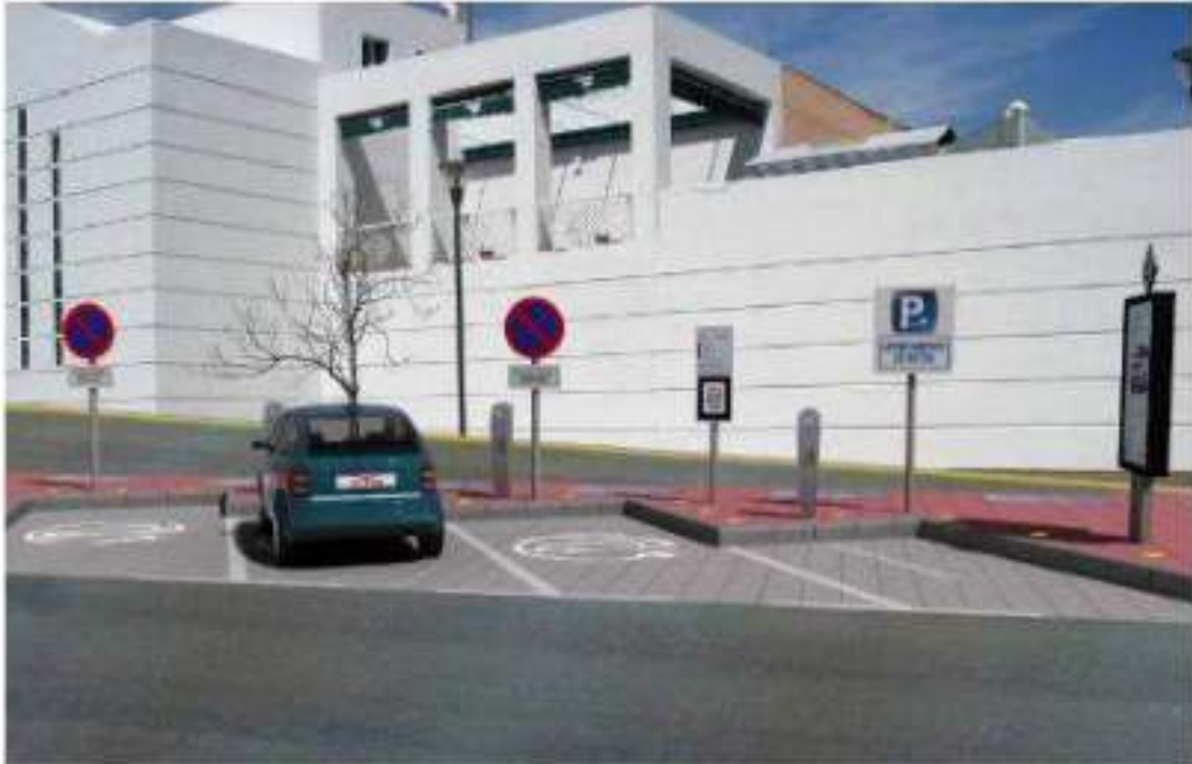
Modelo de estación de recarga en ángulo con puntos dobles y recarga independiente para motos. Fuente: ACTISA
