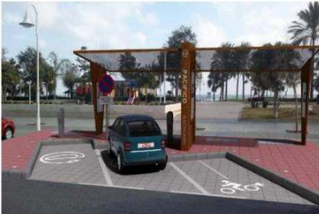
Modelo de estación de recarga en ángulo con puntos dobles y recarga independiente para motos y con marquesina fotovoltaica asociada. Fuente: ACTISA
